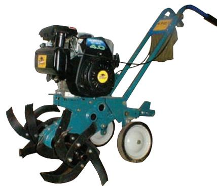
Мотокультиватор типа “Крот” с карбюраторным двигателем Honda.
