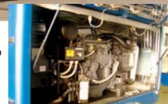
Установка электроагрегата АДС (двигатель DEUTZ + генератор SINCRO) P-120kW, напряжение 650 В постоянного тока на троллейбусе.
