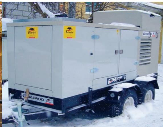
АДС 135-Т 400 РК на прицепе в шумозащитном кожухе. Изготавливается для МЧС.
