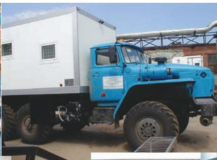
Электроагрегат АДА8-230РЛ установлен под кунгом на вахтовых вездеходах для обслуживания вездеходов
