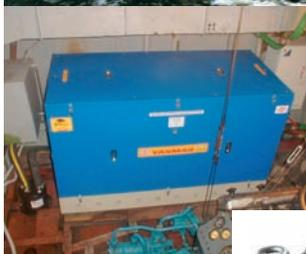
Судовой электроагрегат 8 кВт + 2 главных двигателя 260 л. с. устанавливается на катерах, проект "Вишера"
