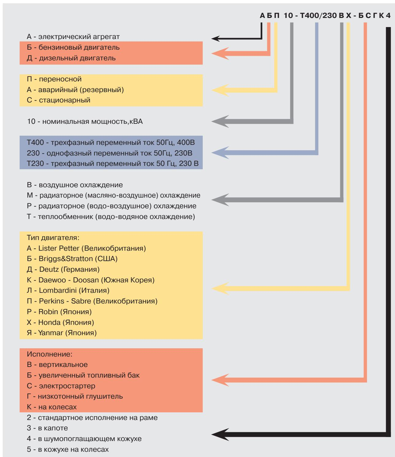
Согласно ТУ, принятых производителем, наименование сварочного электроагрегата расшифровывается следующим образом:
